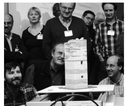
Die obersten Geschosse hat der Erdbebenrütteltisch bereits zum Einsturz gebracht Foto: amt
