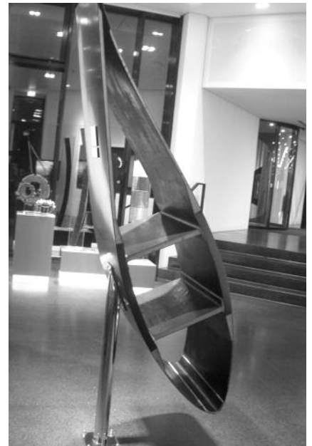
Ein Flugzeugflügel aus Carbon in den Räumen der SGL Group Foto: Luy
