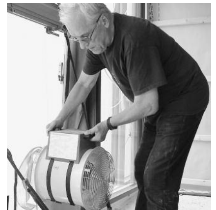
Siegfried Stannek macht den blower-door-Test Foto: KUK Filmproduktion
