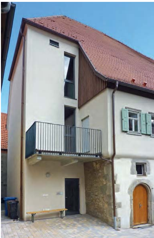
Abb. 69, 70 Barrierefreiheit im öffentlichen Raum: additiver Außenaufzug und Fluchtweg im rückwärtigen Gebäudeteil (links) zugunsten der unveränderten Hauptfassade mit Zierfachwerk (Fotos: Klaus-Jürgen Edelhäuser)
