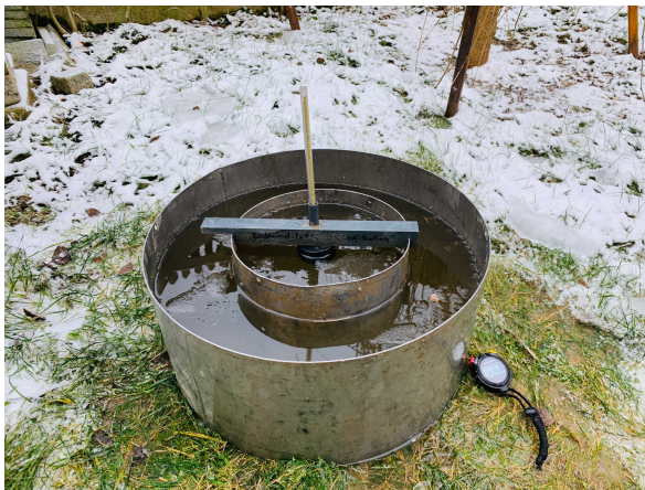
Abb. 6: Überprüfung der Sickerfähigkeit mittels Doppel-Ring-Infiltrometerversuch (hier: bewachsene Bodenzone)
