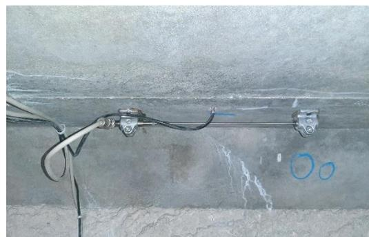
Bild 5: Induktiver Wegaufnehmer mit Extensometerstab zur Erfassung der Betonoberflächendehnung (Foto: MKP GmbH)
