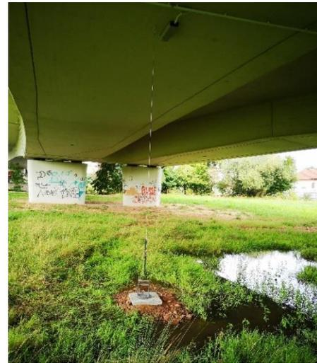
Bild 16: Messung der Durchbiegung des Überbaus mittels Wegaufnehmer (Foto: MKP GmbH)
