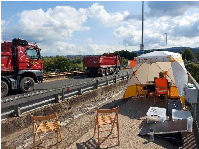
Bild 15: Belastungsfahrzeuge auf der Fuldabrücke mit temporärer Messstation (Foto: MKP GmbH)
