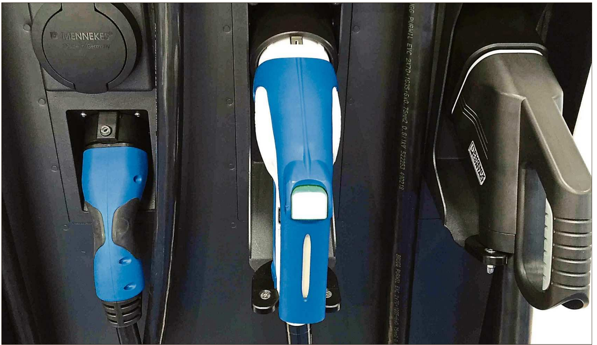
AC/DC Ladekabel in der Ladestation.
